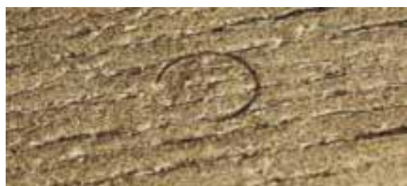
Twardość deski VENIFLOOR – delikatny ślad na powłoce lakierniczej.
